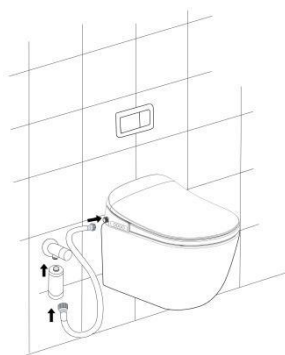
Suministro de agua al lado del inodoro.
